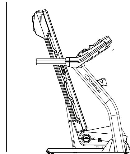
6. Правой рукой нажмите и удерживайте в нижнем положении кнопку освобождения беговой платформы. Используя подъемную рукоятку, располагающуюся под задней поверхностью бегового полотна, поднимите беговую платформу вверх до максимально досягаемого положения и активируйте гидравлический подъемник. Как только беговая платформа переместится приблизительно на 10 дюймов (25,4 см), можно отпустить кнопку освобождения беговой платформы. Проверьте надежность фиксации гидравлического подъемника на месте.
